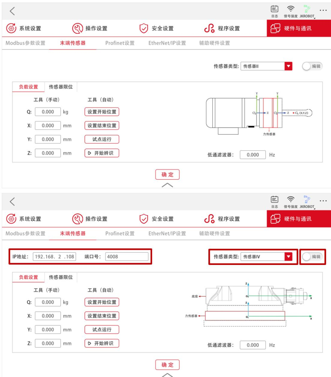
图 3-18 Sp 系统配置界面（IV 底座型）
