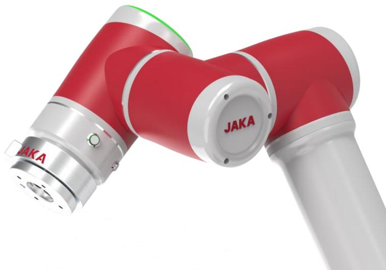
JAKA Zu s 系列协作机器人力控产品配置工业级的力觉传感器，集成自主知识产权的力控算法，提高协作机器人本体的感知能力，为客户提供更好的人机交互体验和安全保障，可以实现：
