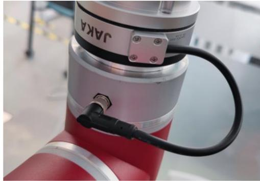
图 2-35 线缆连接操作
