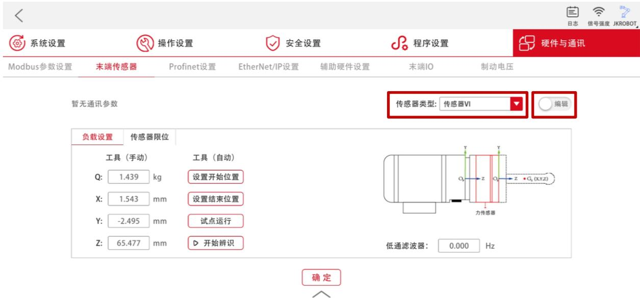
图 3-7 Se 系统配置界面（TIO 型）
