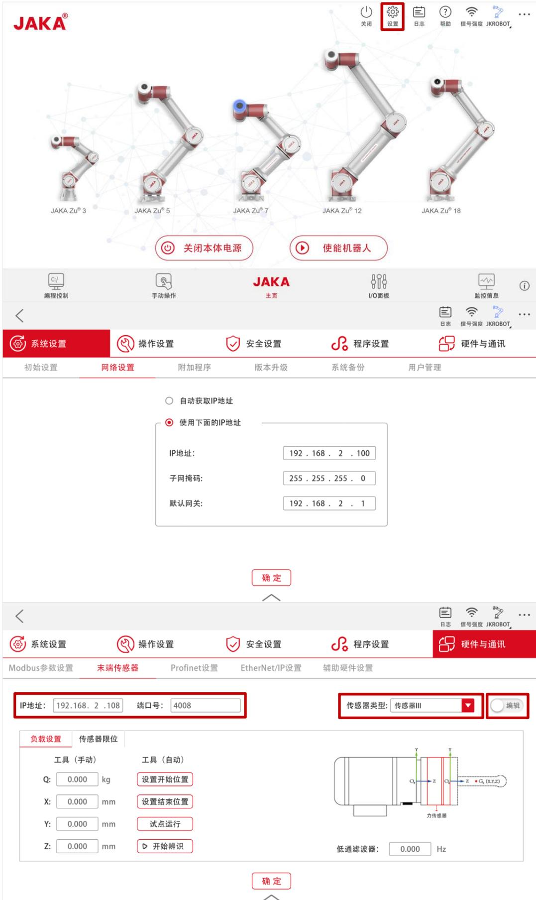
图 3-2 Se 系统配置界面 (I/III 网口型)
