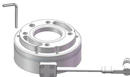
图 2-28 3mm 内六角扳手旋松内埋式螺钉
