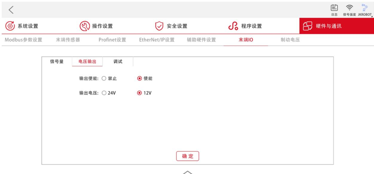
图 3-5 VI 型力觉传感器通电配置界面
