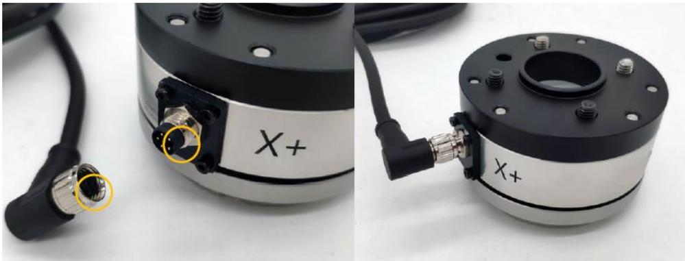
图 2-10 线缆连接操作
