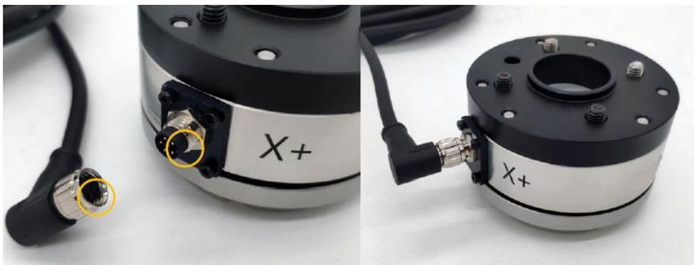
图 2-22 线缆连接操作
