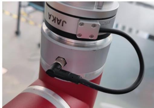
图 2-30 线缆连接操作
